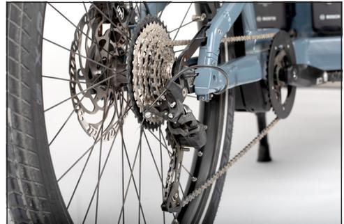
**Bild:** Sprocket with rear derailleur on rear wheel
