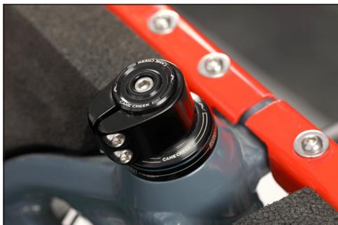
**Bild:** Steuersatz an der Gabelschaftklemmung
