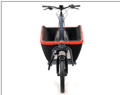
**Bild:** Lenkervorbau und Lenker korrekt ausgerichtet
