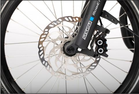
**Bild:** Bremscheibe am Vorderrad
