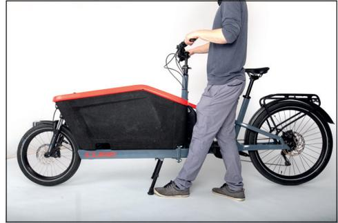
**Bild:** Cargo Hybrid beim Ein-/Aussteigen sicher festhalten
