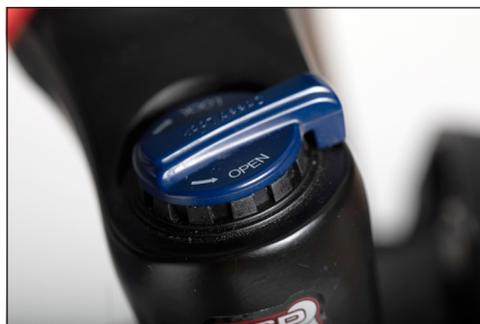
**Bild:** Suspension fork open (=OPEN)
