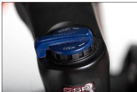
**Bild:** Suspension fork locked (=LOCK)
