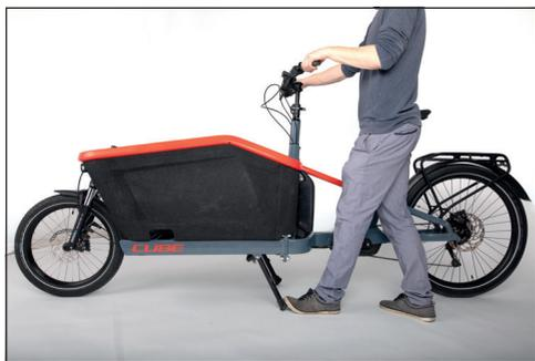
**Bild:** Folding out the kickstand
