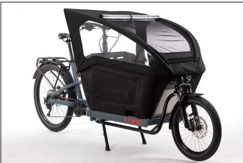
**Bild:** Regenverdeck an Box montiert
