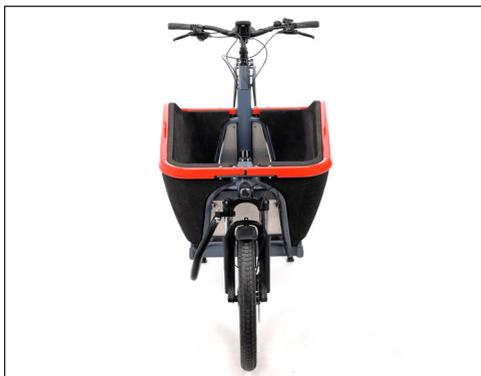
**Bild:** Stem and handlebars correctly aligned
