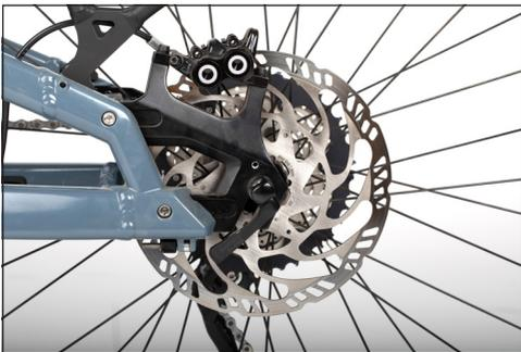
**Bild:** Bremscheibe am Hinterrad
