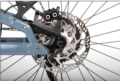
**Bild:** Brake disc on the rear wheel
