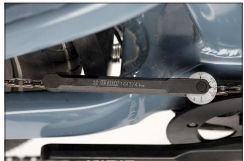
**Bild:** Chain wear gauge
