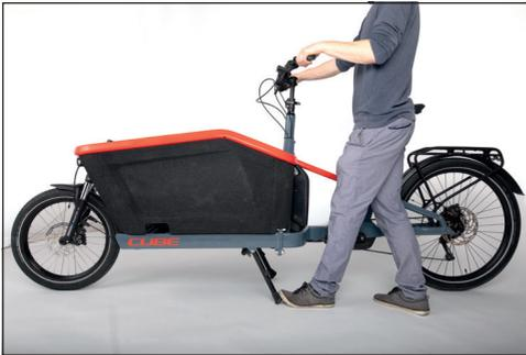
**Bild:** Ständer ausklappen
