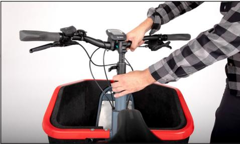
**Bild:** Adjusting the handlebar height
