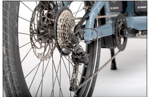
**Bild:** Zahnkränze mit Schaltwerk am Hinterrad
