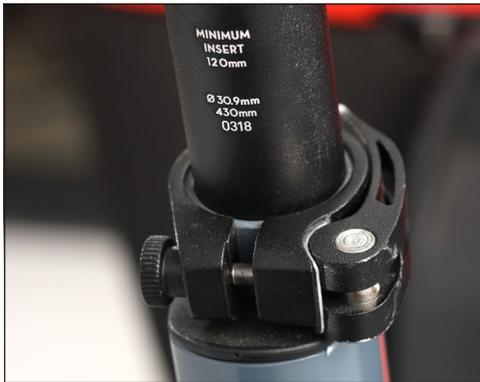
**Bild:** Markierung für die Mindeinstecktiefe der Sattelstütze
